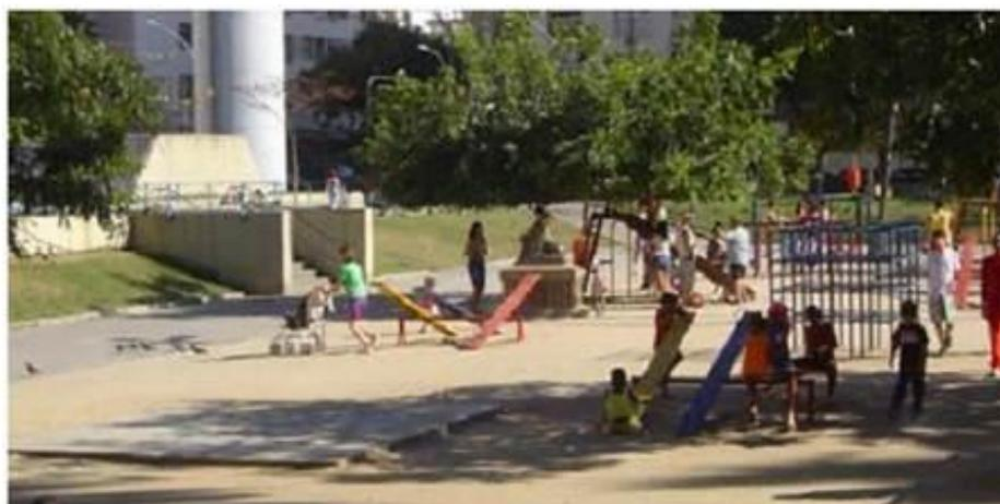
Figura 3: Exemplo de reservatórios de retenção de usos múltiplos
