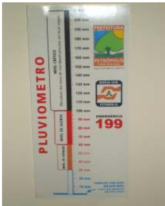
Figura 11 – Foto da régua distribuída pela COMDEC - Petrópolis para elaboração do pluviômetro caseiro de garrafa Pet contendo os níveis de atenção, alerta e crítico
