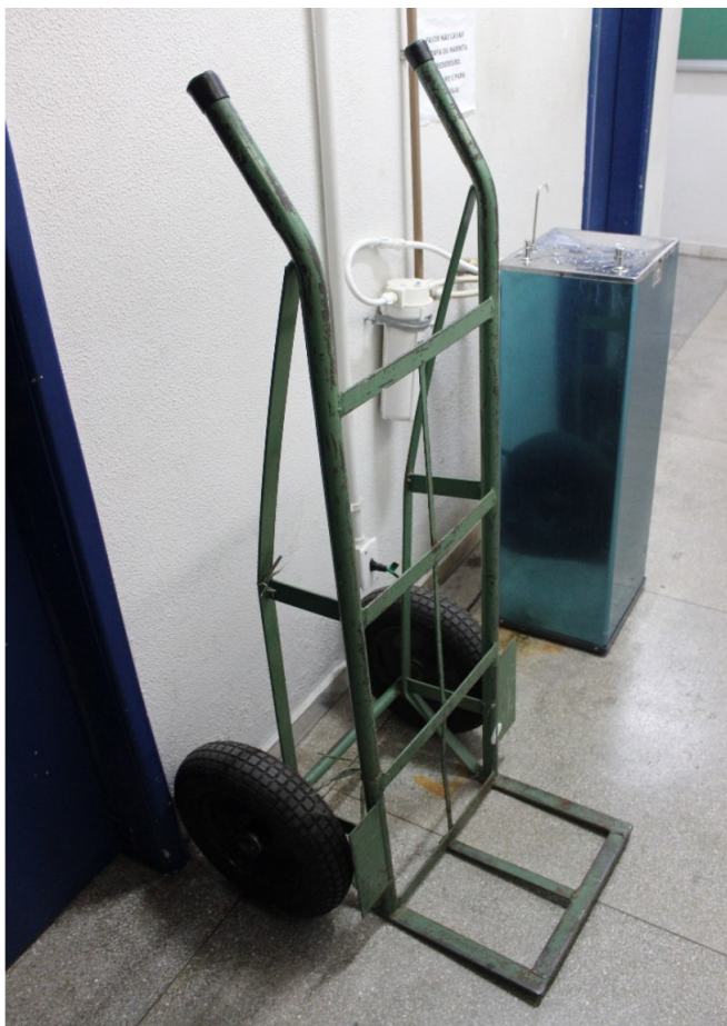
Figura 18 - Carrinho utilizado para transporte interno de resíduos químicos
