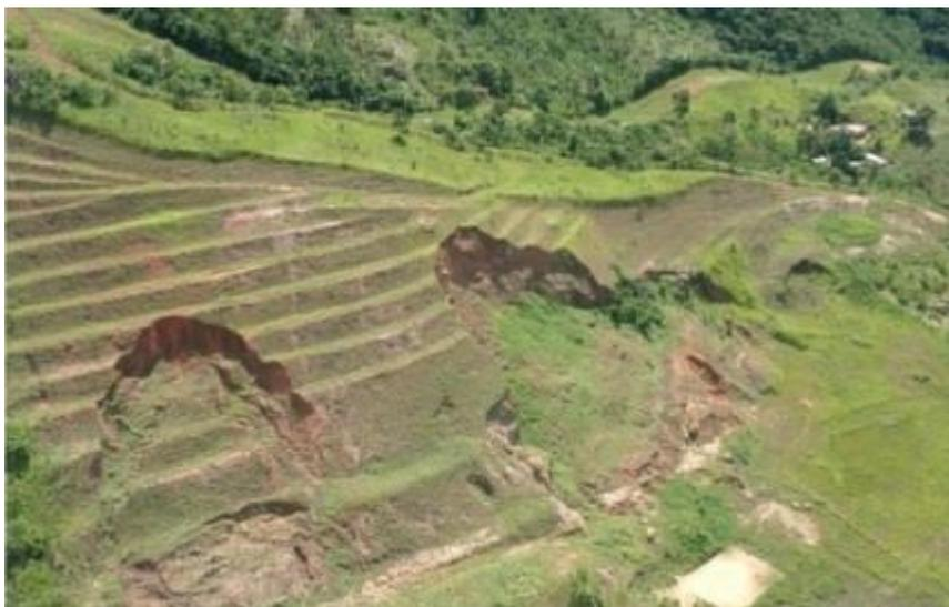
**Figura 2.1:** Escorregamento rotacional ou circular. Fonte: modificado de CASTRO, 2012.
