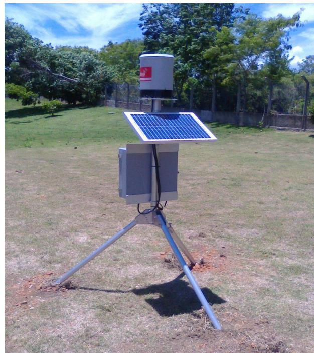
Figura 3 Pluviômetro automático
