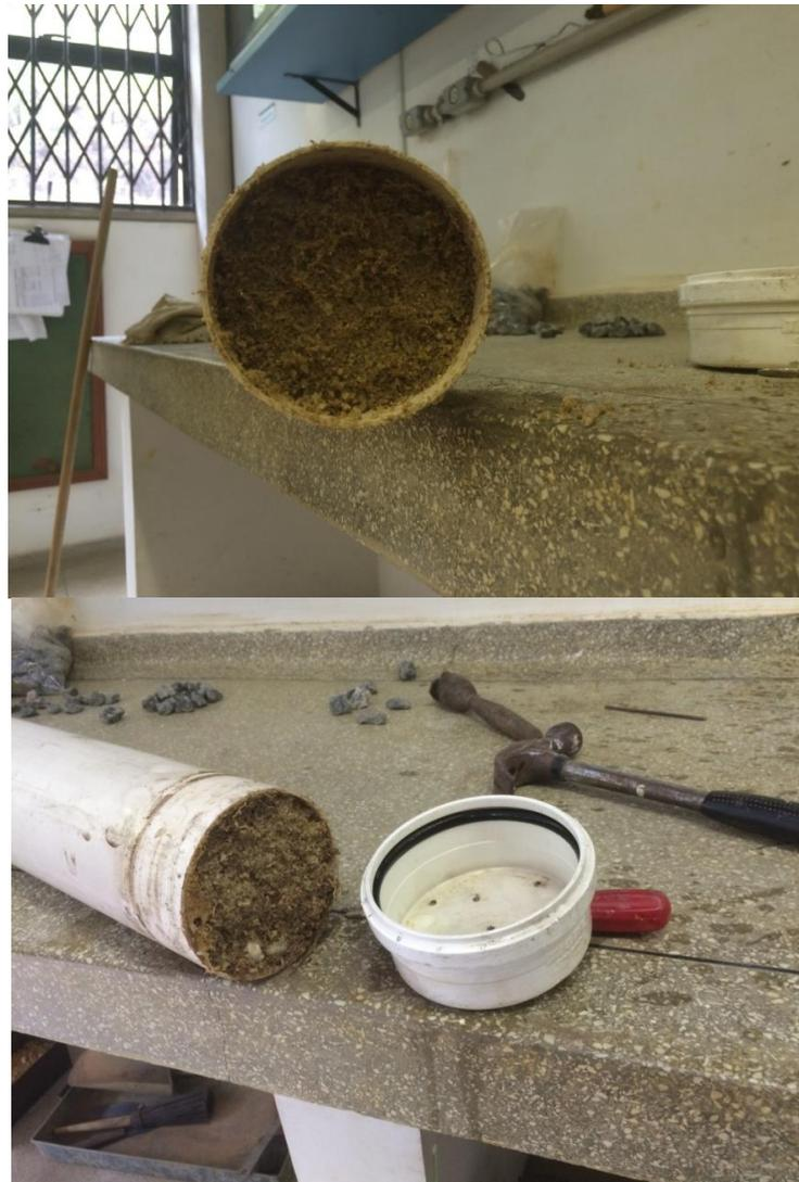
Figura 8: Fundo do mini-lisímetro: detalhe do cap perfurado
