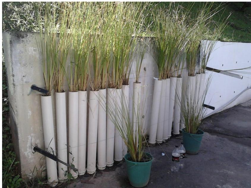
Figura 4: Aspecto do vegetal nos tubos onde 4 deles foram convertidos em mini lisímetros
