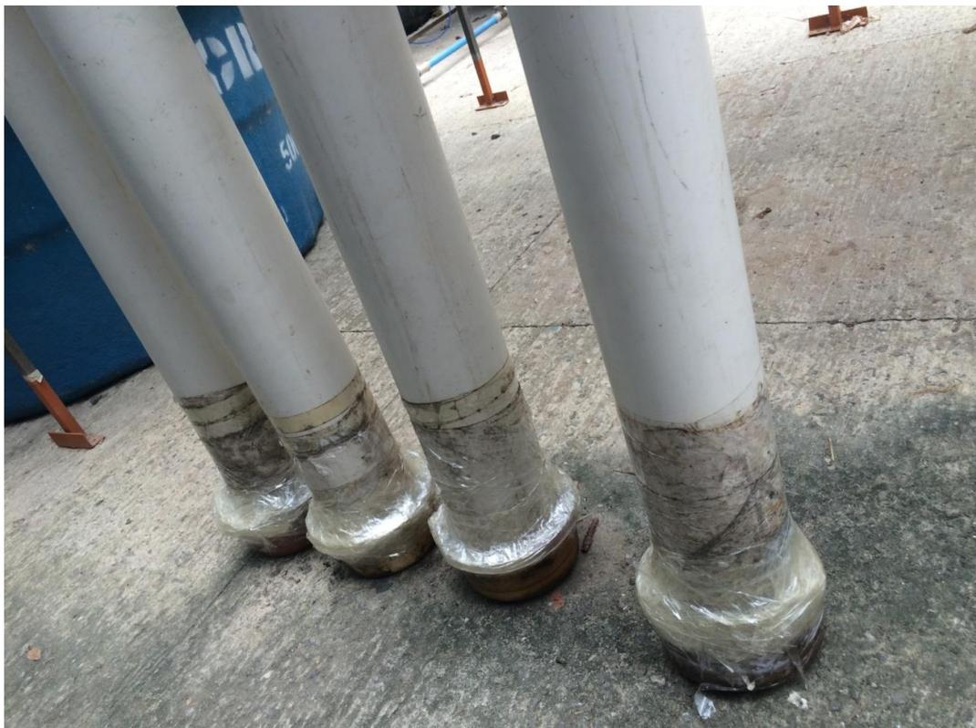
Figura 11: Vedação dos mini-lisímetros
