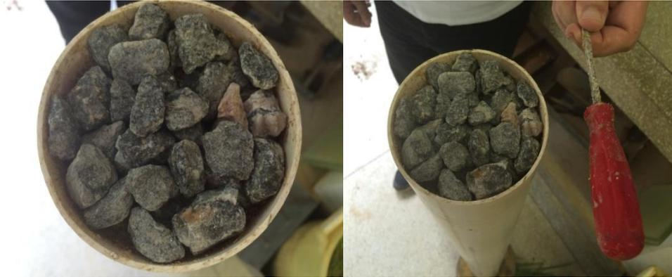
Figura 7: Detalhe do filtro no fundo do lisímetro
