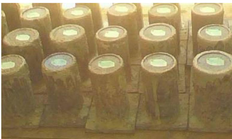
13-Mostra em detalhe os corpos de prova dos concretos acima referidos, com etiqueta de identificação ostentando o nome da empresa responsável pela usinagem, localização da estaca e data de execução da moldagem.
