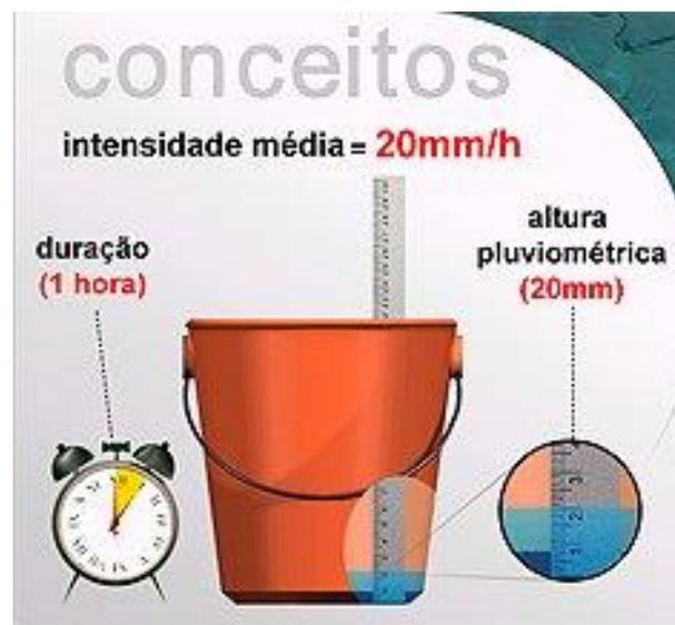
**Fig. 30 – Pluviômetro caseiro com uso de balde.**
