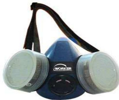
**Figura 13:** Respirador purificador de ar de segurança semifacial, recomendado para ambientes com concentrações mais altas de contaminantes. Podem ser utilizados com filtros para partículas, fumos, névoas, gases ou vapores (MASTROENI, 2006, p. 18-19).
