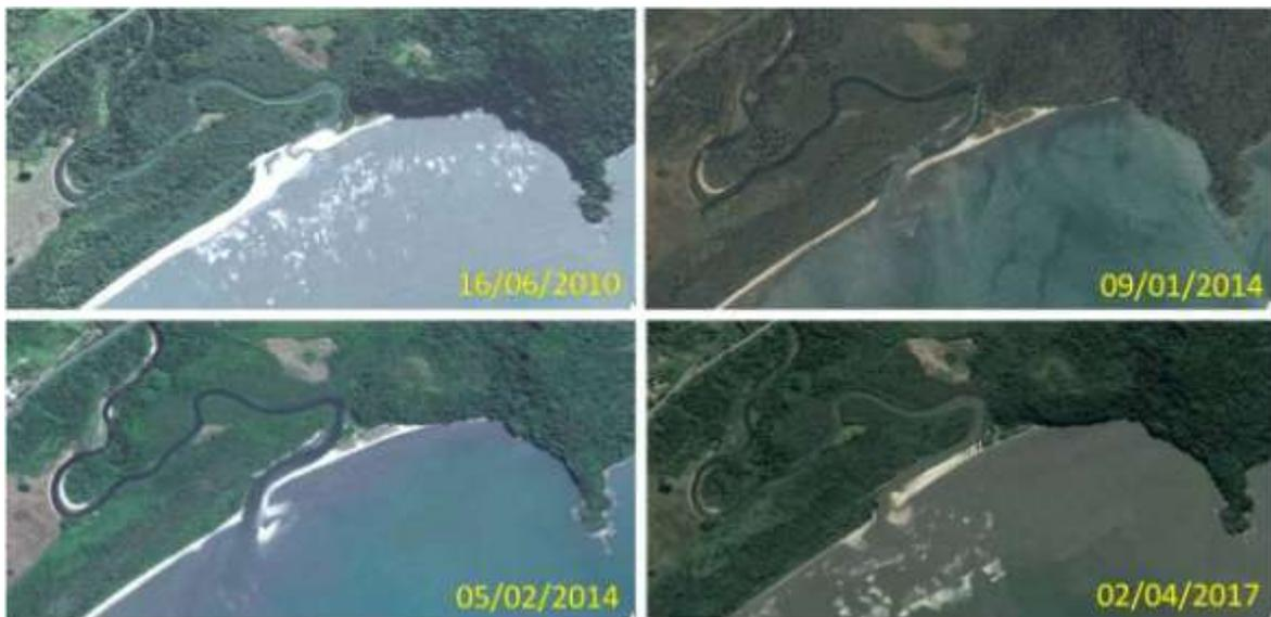
Figura 16 – Alterações na faixa de areia da praia do Taquari devido às variações das condições hidrodinâmicas e ao balanço de sedimentos próximo a foz do rio Taquari.
